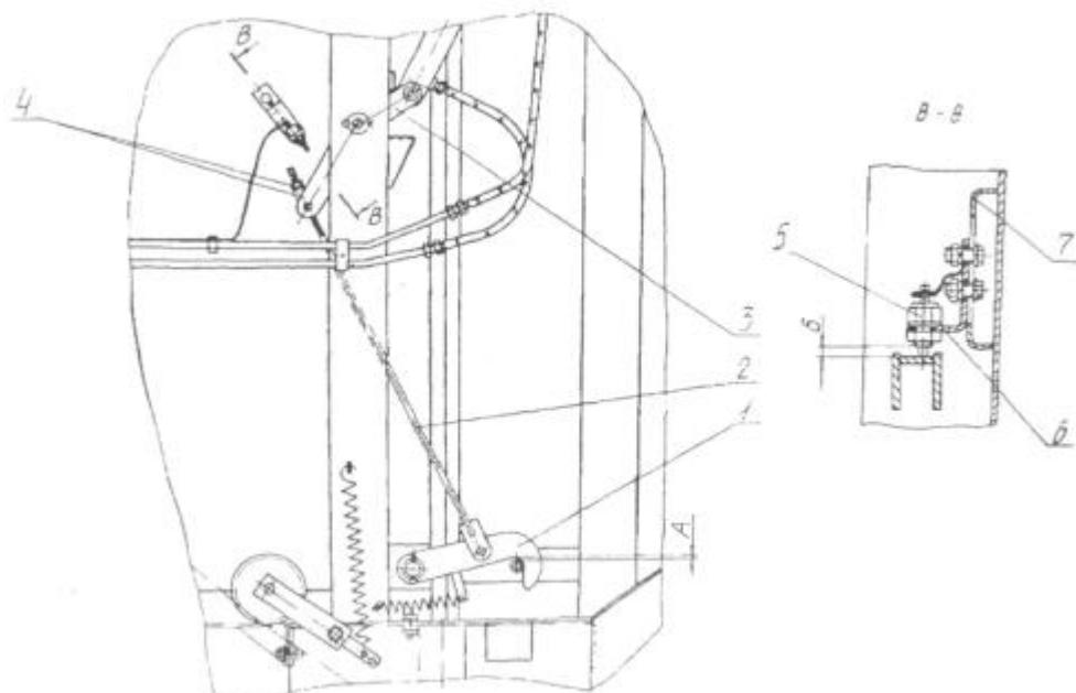
1 – защелка; 2 – тяга; 3 – рычаг; 4 – гайки; 5 – датчик; 6, 7 – кронштейны.
