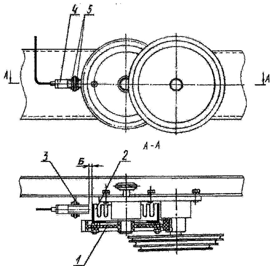
1 – шестерня; 2 – диск; 3 – кронштейн; 4 – датчик; 5 – гайки.
