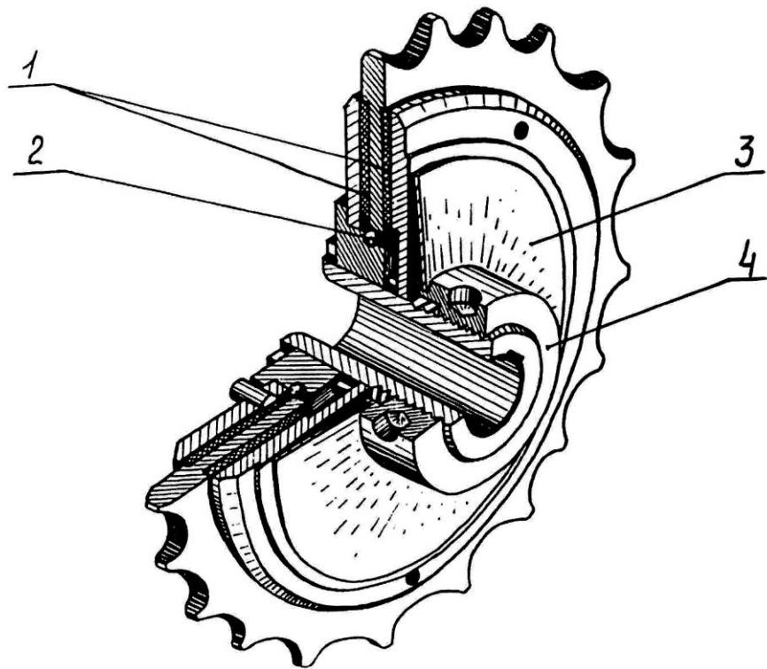
1 – накладка фрикционная; 2 – шарик; 3 – пружина тарельчатая; 4 – гайка.
