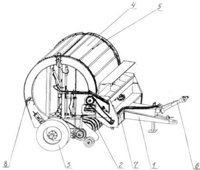
1 – лобовина; 2 – подборщик; 3 – основание камеры; 4 – камера прессования; 5 – механизм прессующий; 6 – передача карданная; 7 – гидросистема; 8 – электрооборудование.
