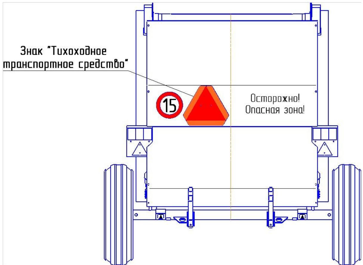
Рисунок 5.2 – Схема установки знака «Тихоходное транспортное средство»
