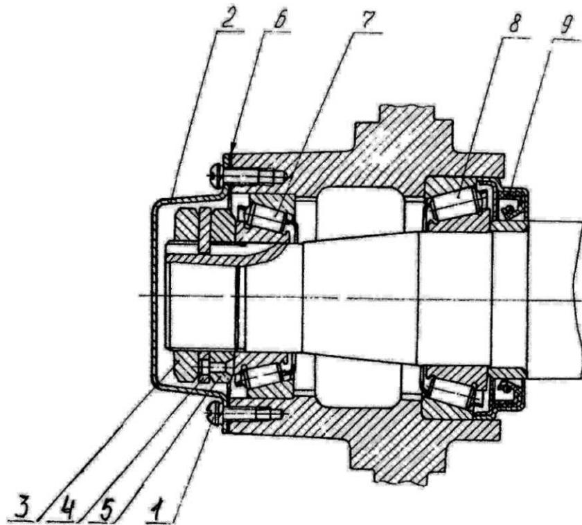
1 – винт; 2 – крышка; 3 – контргайка; 4 – стопорная шайба; 5 – гайка; 6 – прокладка; 7, 8 – подшипники; 9 – манжета.
