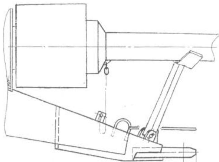
Рисунок 6.1 – Установка кронштейна под карданный вал
