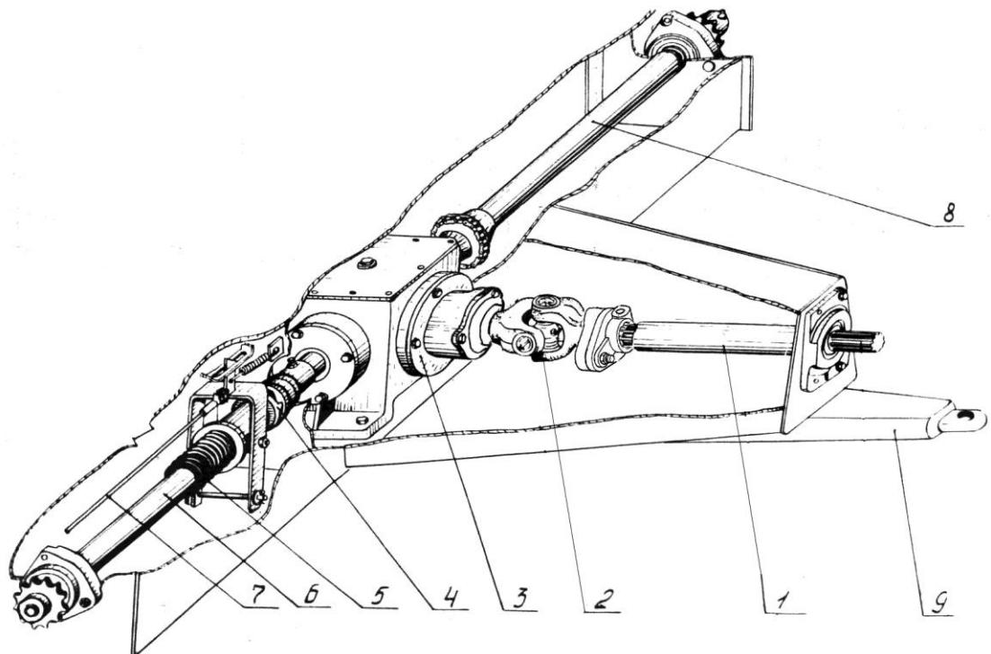
1 – вал приема мощности; 2 – шарнир с предохранительной муфтой; 3 – редуктор конический; 4 – муфта кулачковая; 5 – пружина; 6 – вал привода механизма прессующего; 7 – тяга; 8 – вал привода вальцев; 9 – петля.
