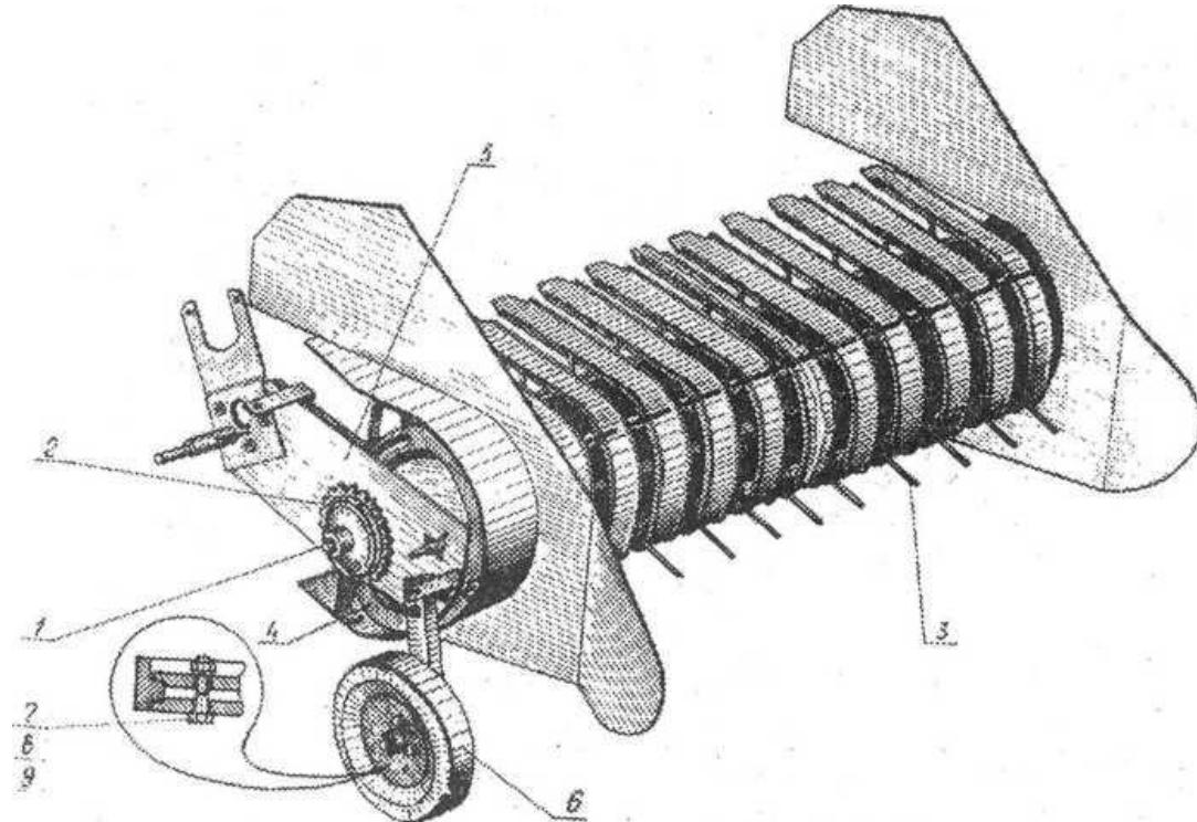
1 – вал приводной; 2 – муфта предохранительная; 3 – зубья пружинные;
