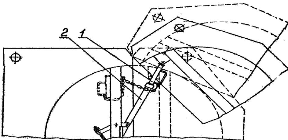
1 – предохранительный упор (фиксатор), 2 – гидроцилиндр.
