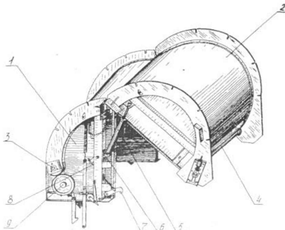
1 – камера передняя; 2 – камера задняя; 3 – вал ведущий; 4 – ось; 5 – гидроцилиндр; 6 – рычаг; 7 – защелка; 8 – тяга; 9 – валец верхний.
