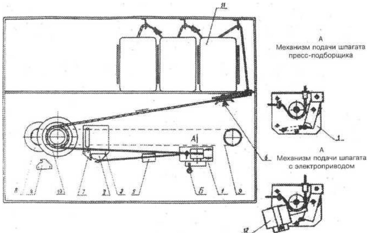
1 – механизм подачи; 2 – каретка; 3 и 4 – поводок; 5 – упор; 6 – тормоз; 7 – нож; 8 – механизм привода каретки; 9 – цепной контур; 10 – шкив; 11 – бобина; 12 – электропривод.
