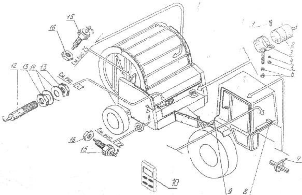
1 – болт; 2 – электродвигатель; 3 – кронштейн; 4, 14 – шайба; 5, 6, 13, 16 – гайка; 7 – хомут; 8 – провод питающий; 9 – кабель; 10 – пульт индикации; 12 – датчик; 15 – выключатель кнопочный.
