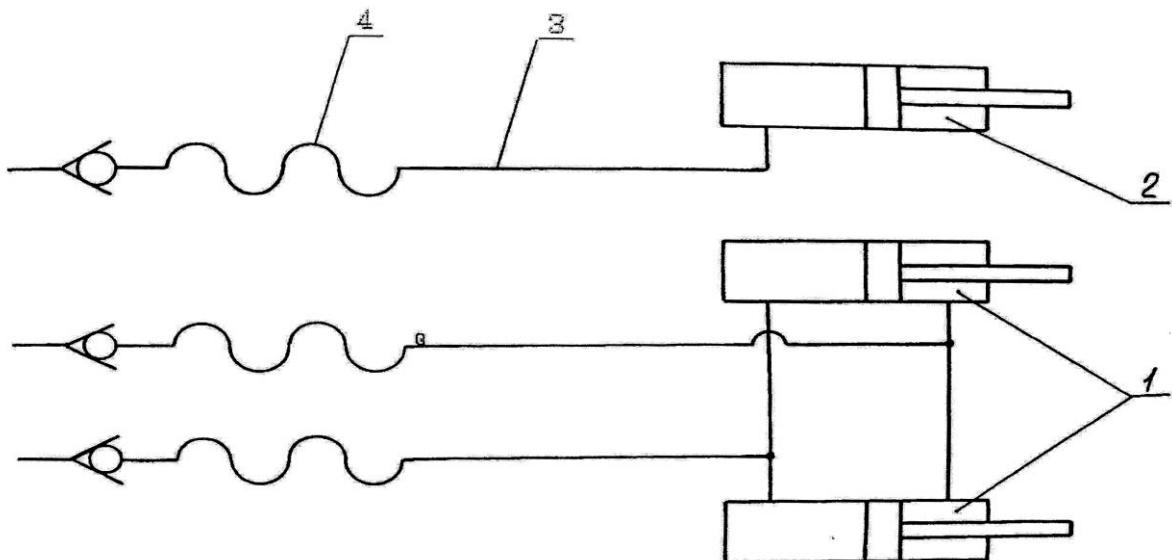
1, 2 – гидроцилиндры; 3 – трубопроводы; 4 – рукава высокого давления.
