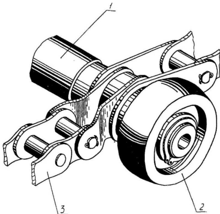
1 – планка (скалка); 2 – роликовая опора (каток); 3 – цепь
