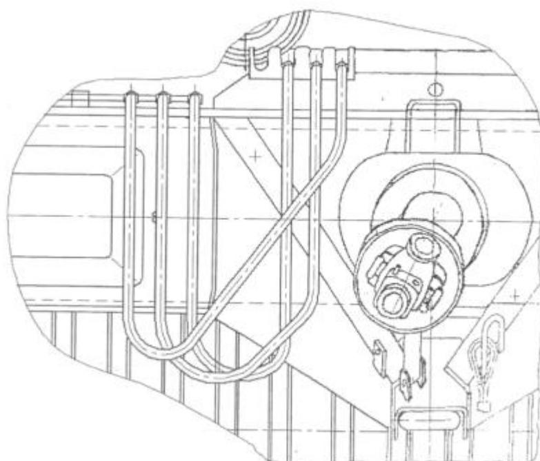
Рисунок 6.2 – Схема установки рукавов высокого давления
