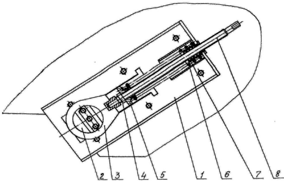
1 – основание; 2 – ось прессующего механизма; 3 – серьга со вставкой; 4 – гайка М16; 5 – гайка; 6 – пружина; 7 – пружина; 8 – шпилька.
